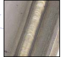
Saldatura testa a testa con Inomaxx TIG acciaio inossidabile AISI 316L spessore 3 mm
